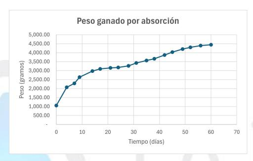
Test realizado en condiciones extremas constantes de 40°C de temperatura y 90% de humedad relativa
